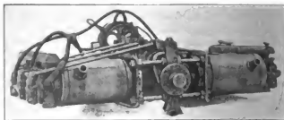
Der 6zylinderige Sunbeammotor. Zu beachten ist die falsche Kurbelverteilung; Bei derselben wird allerdings die Wirkung, wie bei drei Zweitaktzylindern erzielt, aber die Kippmomente und Schlingerbewegungen weichen gross.
